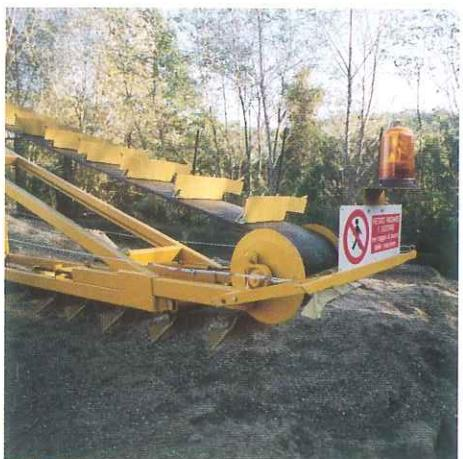
La CENTRALE CAPE si differenzia dai modelli tradizionali a raggi raschianti per il suo unico raggio "GALLEGGIANTE" che permette di convogliare sino a 3 inerti con maggiore silenziosità, prelievo di inerti dall'alto e quindi più puliti e drenati dall'acqua, assoluta precisione del dosaggio grazie al disimpegno del raggio nel passaggio da un inerte all'altro, assenza di regolazioni del
